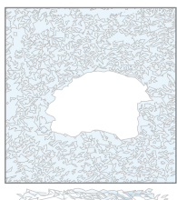
Tipo di frammentazione di un vetro temprato.
